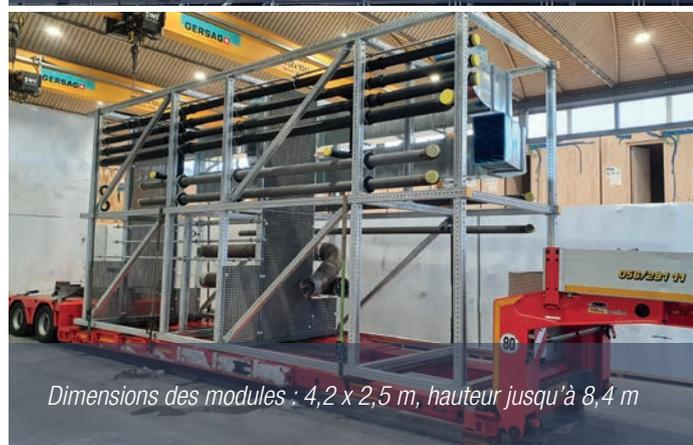
*Dimensions des modules : 4,2 x 2,5 m, hauteur jusqu'à 8,4 m*
